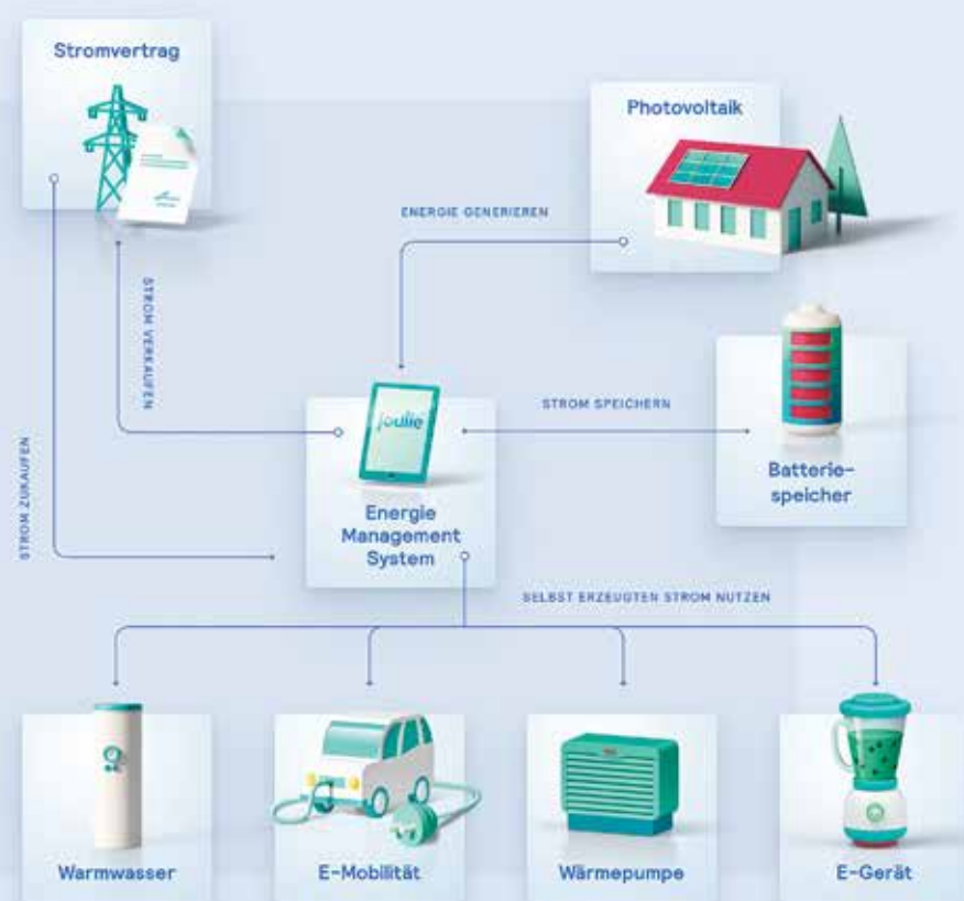
Die eigene Photovoltaikanlage produziert Strom und joulie sorgt dafür, dass die selbst produzierte Energie auch selbst verbraucht wird.
