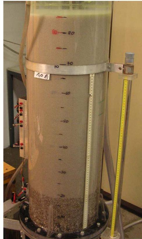
**Abbildung 17: Ausdehnung des Filtersandes um ca. 170 % bei einer Spülggeschwindigkeit von ca. 51 m/h**
