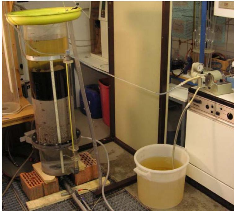
**Abbildung 13: Beschickung mit Eisenchlorid, Variante 1, 8.4.2008**
