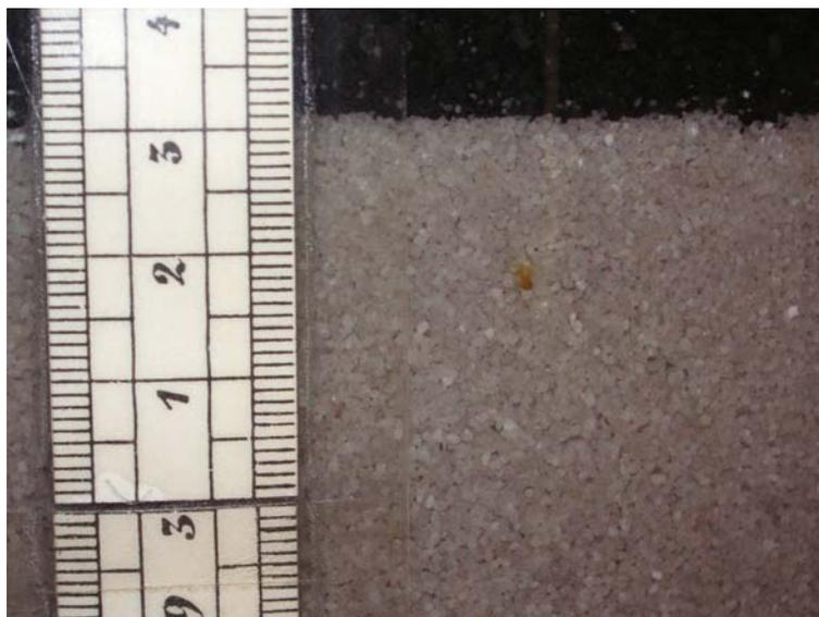
**Abbildung 14: Eisenflocke an Filteraußenwand nach Rückspülen, Variante 1**
