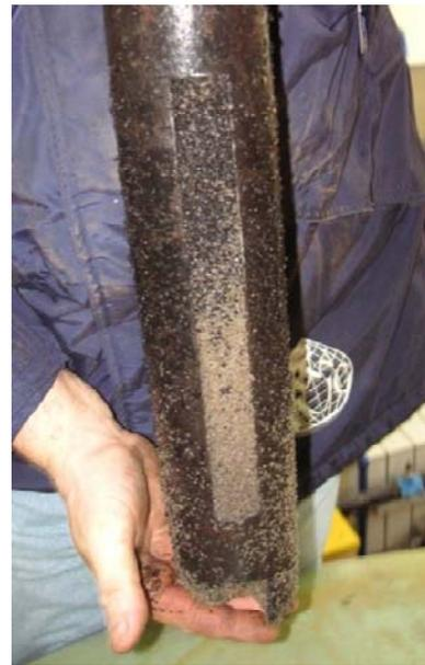
**Abbildung 2: Filter I, Bohrloch (links) und Filtermaterial im Übergangsbereich Hydro-Anthrazit zu Filtersand (rechts)**
