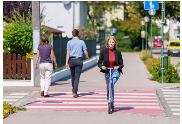
Querungsmöglichkeit durch eine Radfahrerüberfahrt kombiniert mit einem Schutzweg
