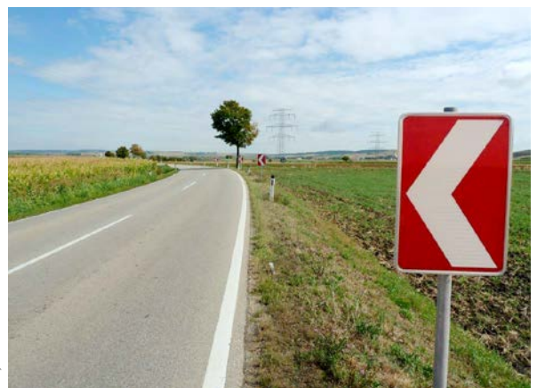
Kennzeichnung des Straßenverlaufs durch Leitwinkel
