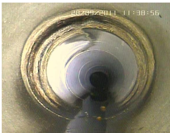
Abbildung 7: Längsriss – keine eindeutige Zuordnung hinsichtlich zeitlicher Veränderung
