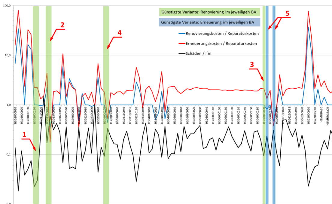
Abbildung 16: Gemeinde 1 – Gegenüberstellung von „Renovierungskosten / Reparaturkosten“ und „Erneuerungskosten / Reparaturkosten“ sowie Anzahl der Schäden pro lfm
